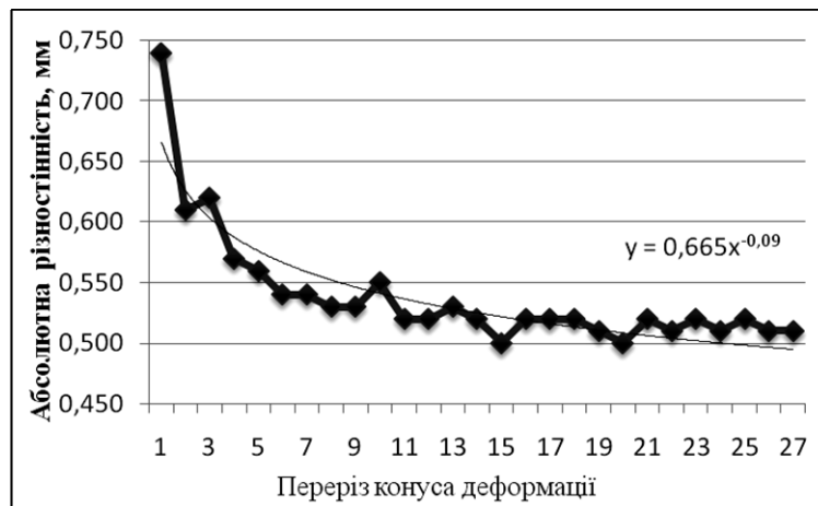
Рис. 1. Графіки зміни абсолютної поперечної різностінності уздовж конуса деформації стана ХПТР 15-30 при прокатці труб за маршрутом 28 \times 3,2 – 25,4 \times 2,65 (перерізи 1–5 – зона редукування; перерізи 5–21 – зона обтиску стінки)
